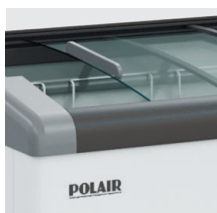
Стекла – закаленные с теплоотражающим покрытием
